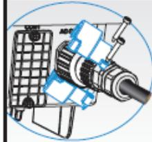
Dopo aver collegato il terminale di **tipo B**, installare il manicotto di protezione nella posizione di connessione e serrare le viti per evitare che i terminali scivolino via.
