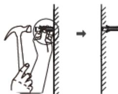
Prestare attenzione a non imprimere troppa forza per evitare di danneggiare il tubo di espansione. Inserire le viti di espansione
