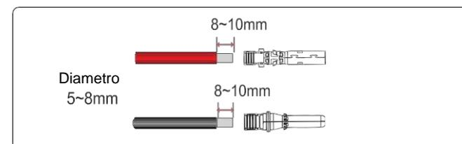
Step 2 Inserire le aree esposte dei cavi positivo e negativo rispettivamente nei terminali metallici dei connettori positivo e negativo e crimarli utilizzando uno strumento di crimpatura. Quindi inserire i cavi crimpati positivo e negativo nei corrispondenti connettori positivi e negativi.
